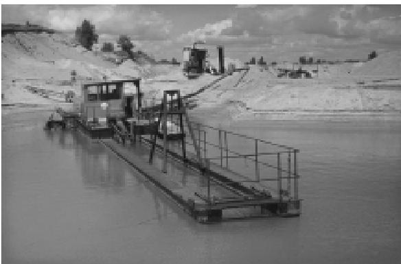
Abb. 69: Nassabbau mit Saugbagger
