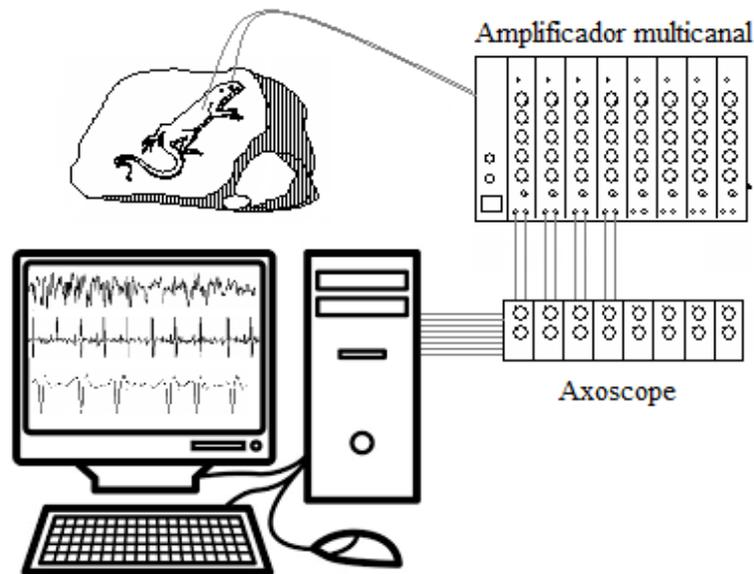
Figura 6. Representación del sistema de registro de las variables EEG, ECG y respiración en un sujeto de *Gallotia galloti*. (Akaârîr, 2007)
